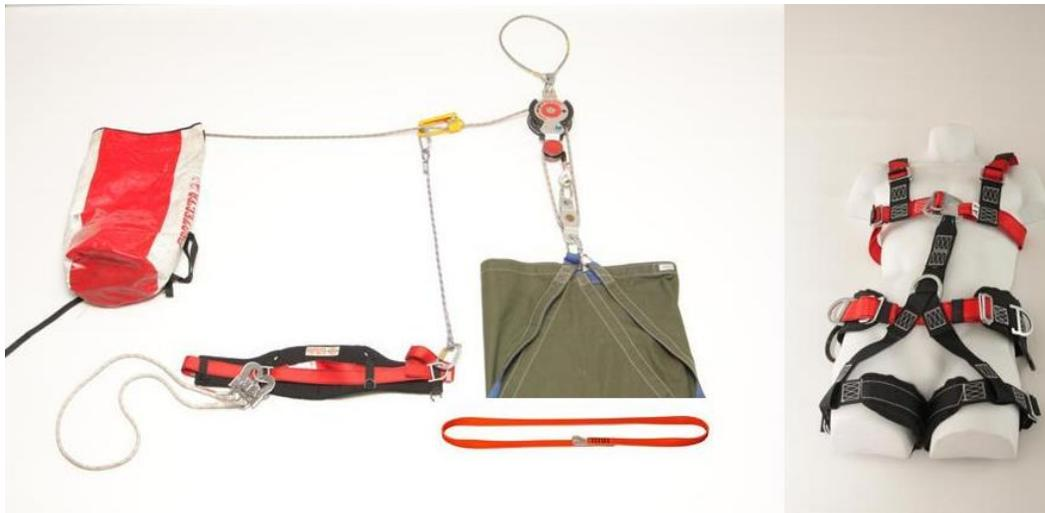
Die Länge des 120 m und 9 mm starken Kernmantelseils ergibt sich aus der Übersetzung von 3 zu 1 und der Rettungshöhe bzw. Rettungstiefe von 30 m.
