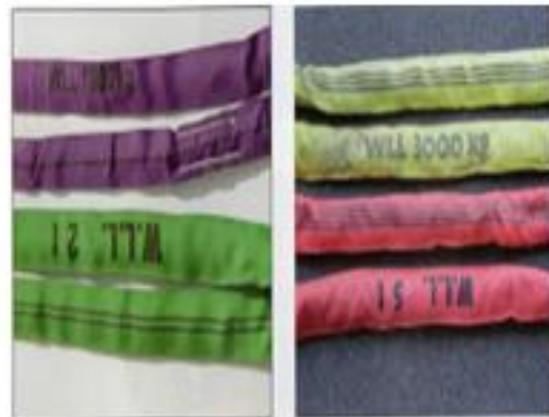
Neben der Farbkennung befindet sich bei Rundschlingen zusätzlich auf dem Schutzmantel umlaufend der Länge nach je 1000 kg Belastung ein eingewebter schwarzer Streifen. Weiterhin ist die zulässige Belastung als Text auf der Gegenseite der umlaufenden Streifen auf der Rundschlinge aufgedruckt.
