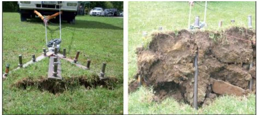
Bild 6: Erdanker mit zwölf gegen die Belastungsrichtung geneigten Erdnägeln in Ton kurz vor dem Tragfähigkeitsverlust (links) und danach (rechts) Erdnägeln in Sand.
