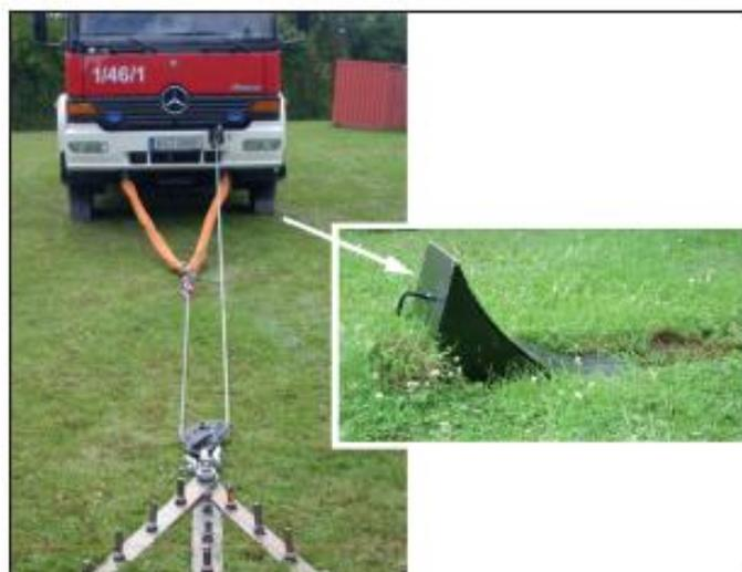
Bild 5: Versuchsanordnung bei Erdankern mit zwölf Erdnägeln (links) und bei Versuchsdurchführung verschobenem Unterlegkeil (rechts).
