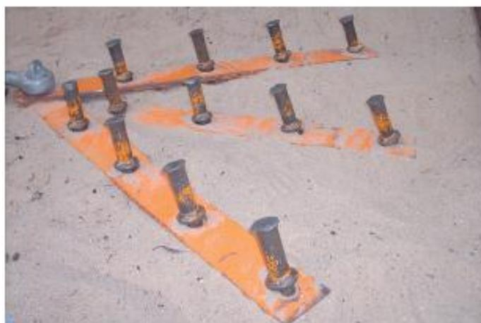
Bild 2: Erdanker mit zwölf in Belastungsrichtung geneigten Erdsnägeln in Sand bei Versuchsbeginn.
