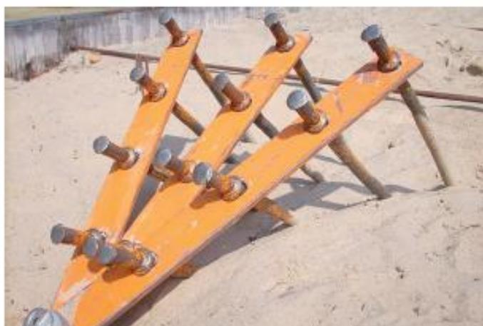
Bild 3: Erdanker mit zwölf in Belastungsrichtung geneigten Erdsnägeln in Sand bei Versuchsende.
