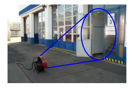
Die Zuluftöffnung muss vollständig durch den Luftstrom des Überdrucklüfters abgedeckt werden.
