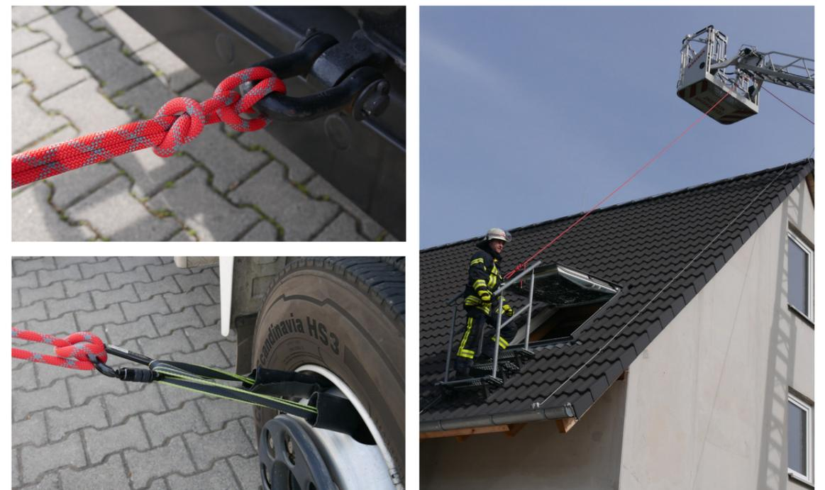
Abb. 33: Beispiel Absturzsicherung. Absturzsicherung mit Hilfe der Drehleiter incl. Möglichkeiten eines Festpunktes. Bild: LFKA RLP
