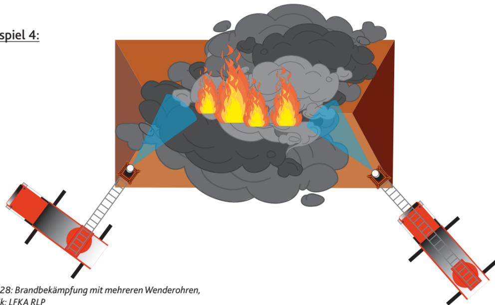
Abb. 28: Brandbekämpfung mit mehreren Wenderohren, Grafik: LFKA RLP
