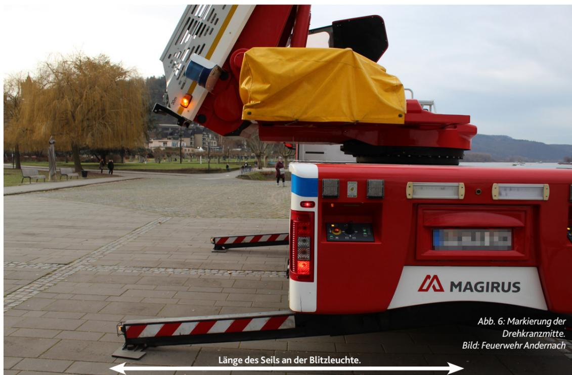
Abb. 6: Markierung der Drehkranzmitte.
